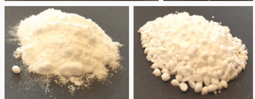
PCM-Proben: Salzhydrat (o. l.), Paraffin (o. r.), Zuckerkalkohol (u. l.) und Fettsäure (u. r.)
