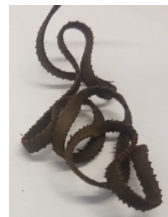
PE mit 70wt% SpreuStrohanteil
