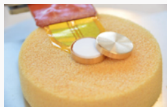
Wärmekapazitätssensor der Hotdisk mit zylindrischer PCM-Probe und Deckel
