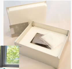
Dreischicht-Kalorimeter zur Bestimmung der spezifischen Schmelzwärme von PCM-Proben
